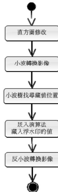
圖 9 影像嵌入浮水印演算法使用流程圖
