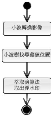
圖 10 影像取出浮水印演算法使用流程圖
