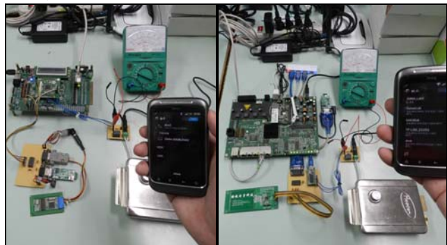
(a) 低階門禁控制器使用 Bluetooth 識別 (b) 高階門禁控制器使用 Wi-Fi 識別 圖 8 使用者於門禁控制器進行識別
