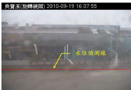
圖 15 直線擬合於水位偵測結果
