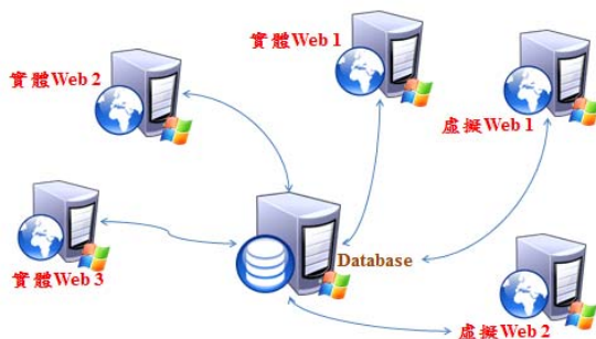
圖 3 選課系統第一階段調整後主機架構圖
