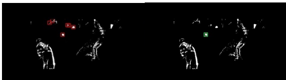
圖 9 形狀過濾結果圖：(a) 輸入影像；(b) 形狀過濾結果影像。圖中紅框為棒球候選區域，經過形狀過濾後，僅剩下棒球本身，以綠框表示。
