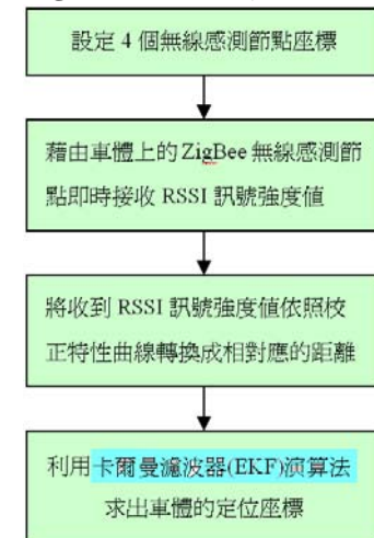
圖 3 ZigBee 無線感測節點定位程序圖
