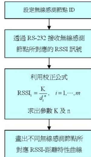
圖 2 ZigBee 無線感測節點校正流程圖
